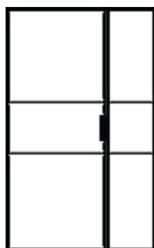
Tür mit Seitenteil rechts
